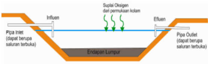
Gambar 16 Ilustrasi pengolahan pada kolam fakultatif
