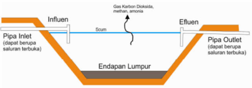
Gambar 15 Ilustrasi pengolahan pada kolam anaerobik
