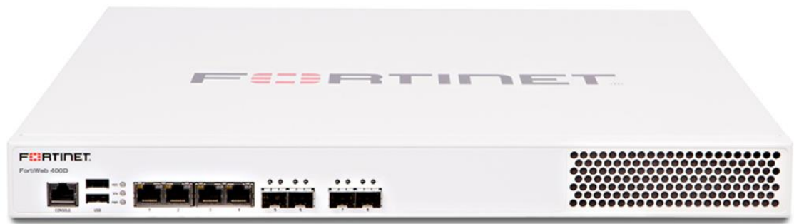
Gambar 34. Perangkat Fortiweb 400D yang berfungsi sebagai Web Application Firewall
