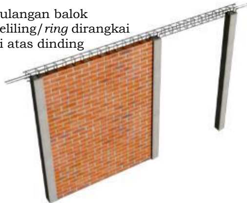
Gambar 59. Perangkaian Tulangan Balok Keliling/ Ring Di Atas Dinding
