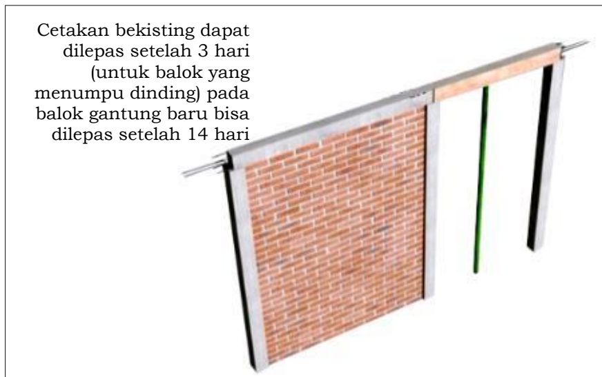
Gambar 61. Pelepasan Cetakan/ Bekisting
