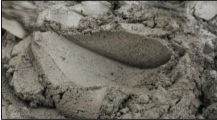
Gambar 9. Hasil Pencampuran Mortar Yang Baik
