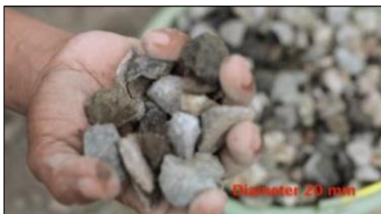
Gambar 5. Diameter Kerikil Yang Baik Untuk Campuran Beton
