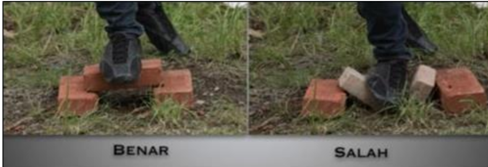
Gambar 13. Pengujian Sederhana Kekuatan Batu Bata
