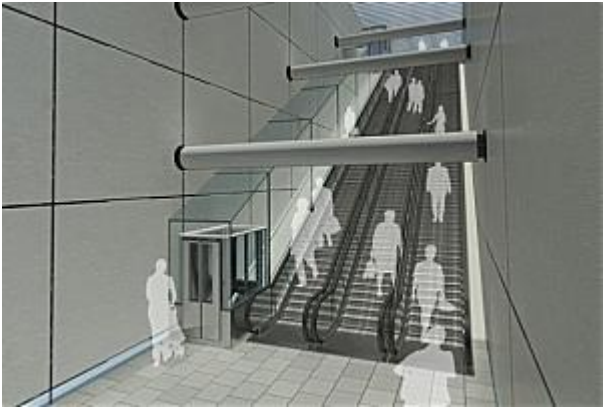
Gambar 2.64. Contoh penerapan incline lift
