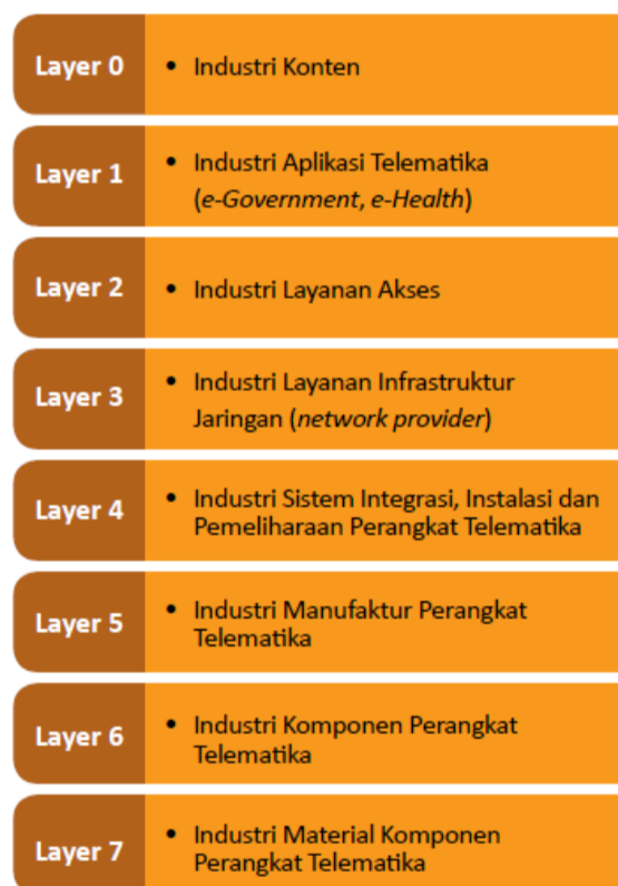
Gambar 3.C.18 Struktur Lapisan Industri Telematika
