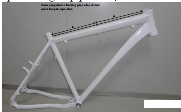
Gambar 4. Cara Pengukuran Keliling Pipa Atas
