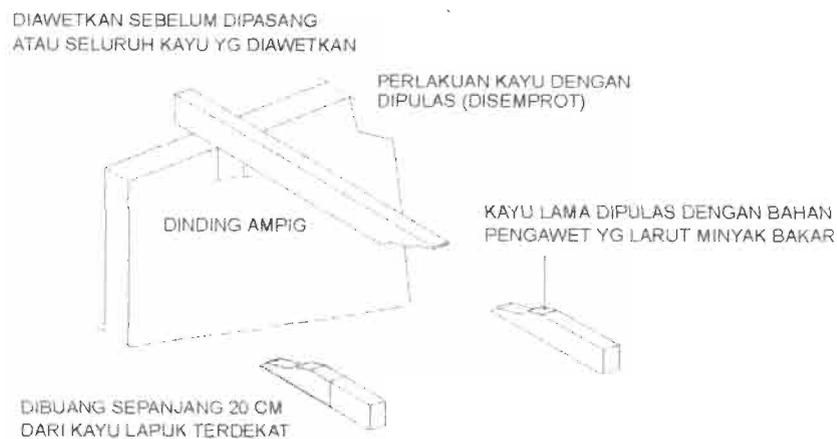
**Gambar 6.8. Perlakuan bagian kayu yang mengalami pemotongan**
