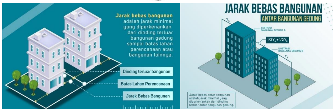
Gambar 35. Ilustrasi Penentuan Jarak Bebas Bangunan Berdasarkan Ketinggian
