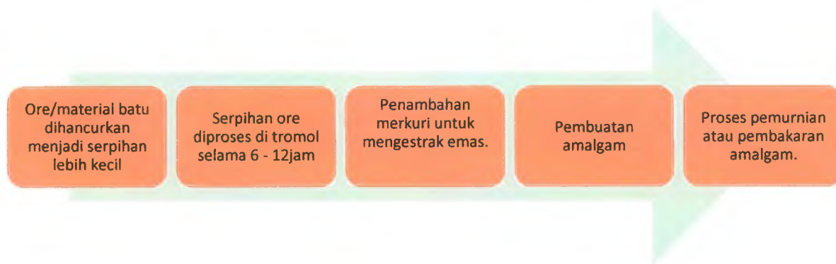
Diagram 3. Alur pengolahan emas pertambangan batu keras
