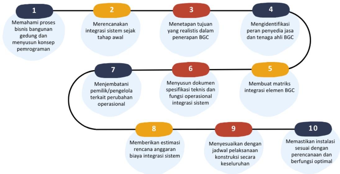
Gambar I.2. Diagram langkah-langkah integrasi sistem pada BGC.
