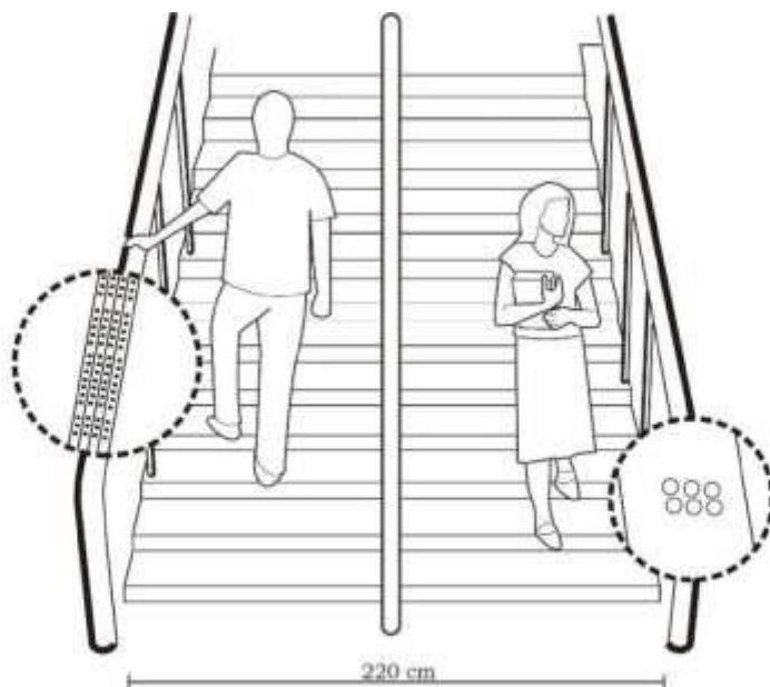
Gambar 2.46. Tangga yang dilengkapi dengan huruf braille di sisi atas pegangan rambatan pada interval tertentu yang menunjukkan posisi anak tangga
