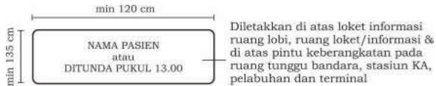
Gambar 3.68. Fasilitas light sign (papan informasi) bagi penyandang disabilitas rungu
