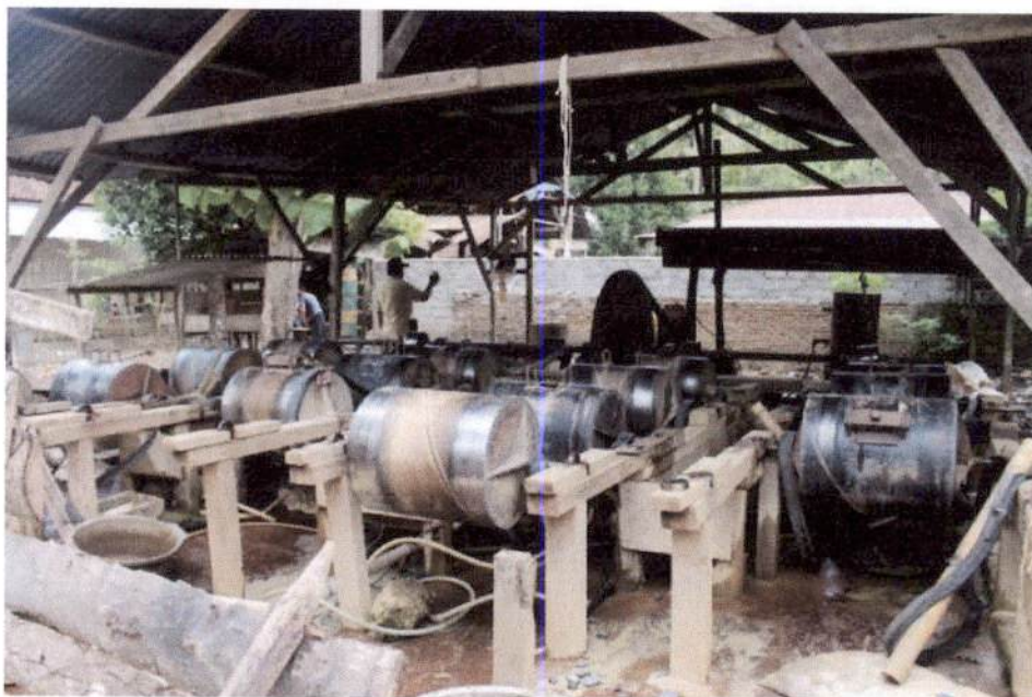
Gambar 7. Tempat pengolahan emas dengan tromol menggunakan merkuri di Kab. Bolaang Mongondow Utara
