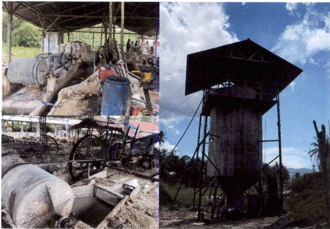
Gambar 10. Ball Mill dan Tanki Sianida di PESK di Tatelu, Kab. Minahasa Utara
