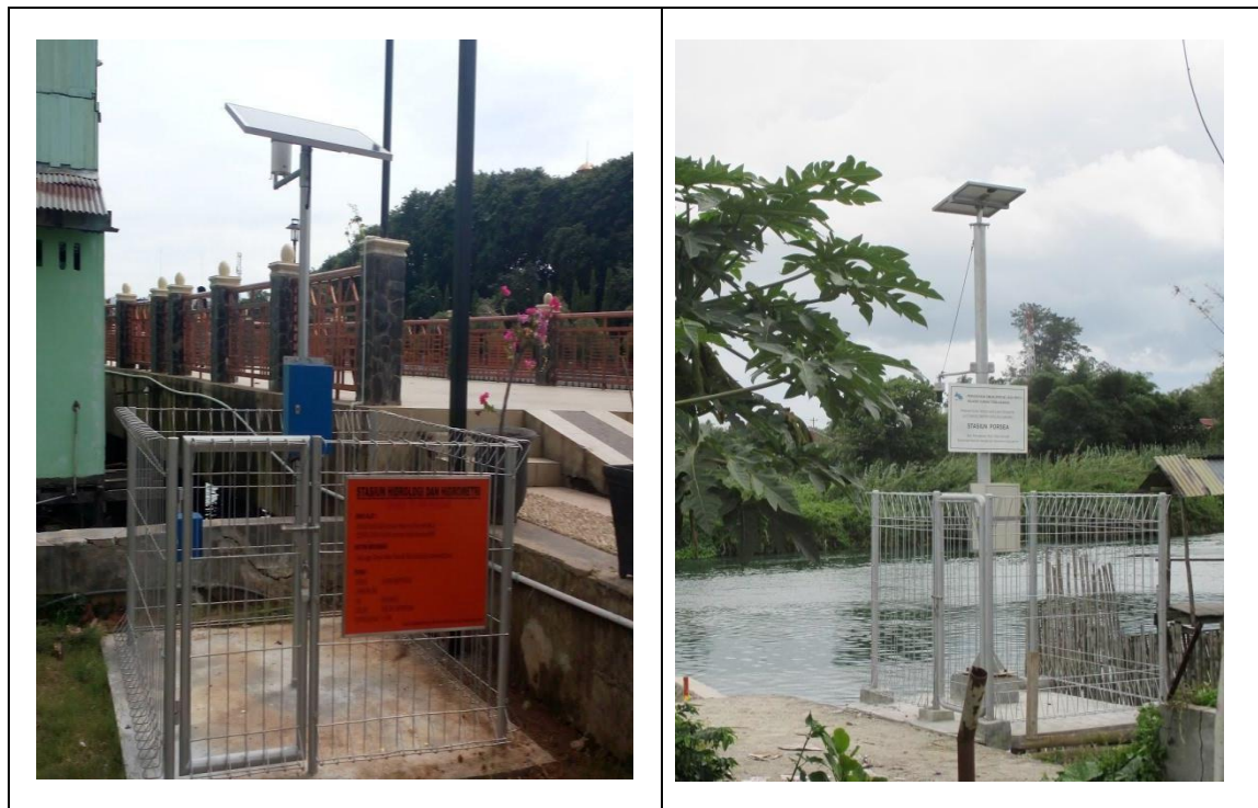
Pilihan 2. Bangunan Pelindung Tidak Permanen
