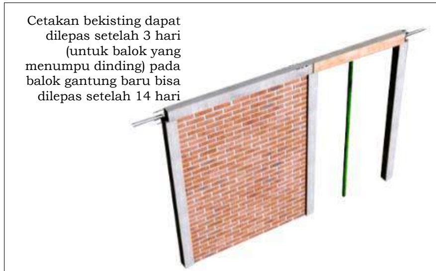
Gambar 61. Pelepasan Cetakan/ Bekisting
