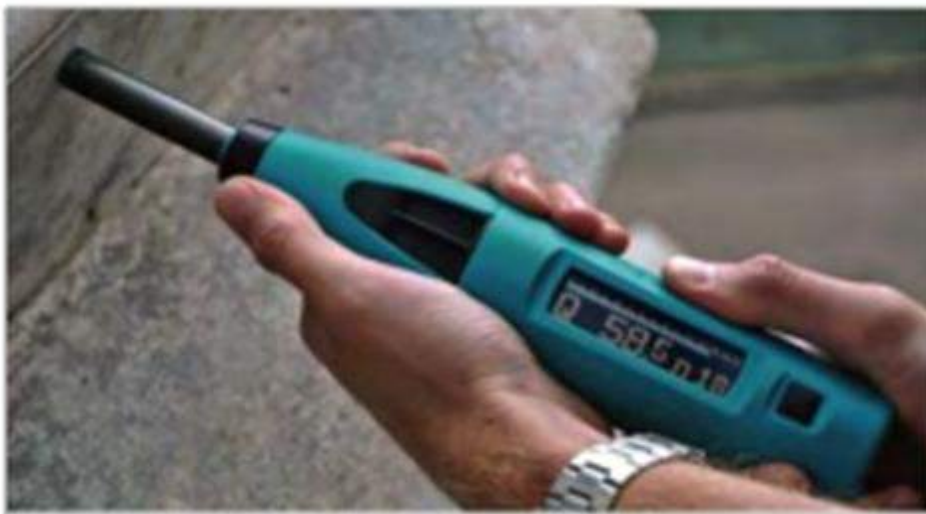
Ilustrasi Pemeriksaan menggunakan Rebound Test Hammer / Concrete Test Hammer/ Palu Beton
