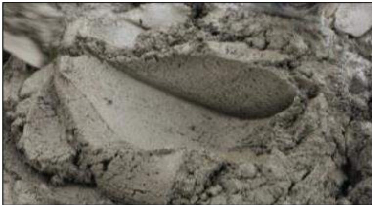
Gambar 9. Hasil Pencampuran Mortar Yang Baik
