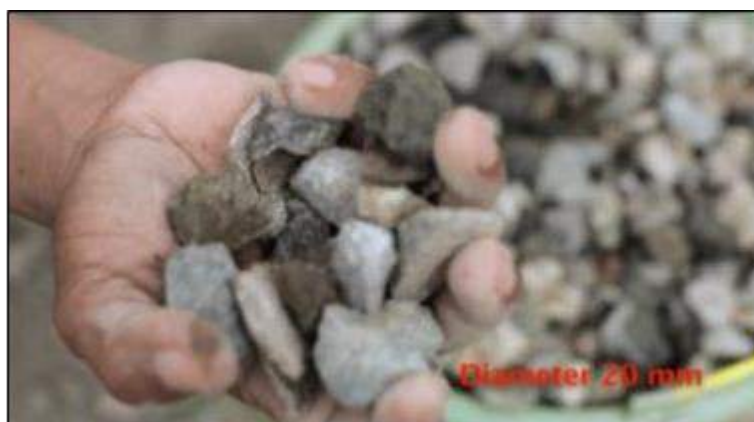
Gambar 5. Diameter Kerikil Yang Baik Untuk Campuran Beton
