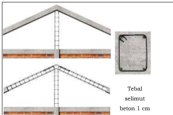
Gambar 33. Tulangan Pada Bingkai Gunung-Gunung/ Ampig
