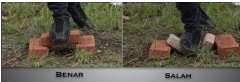
Gambar 13. Pengujian Sederhana Kekuatan Batu Bata
