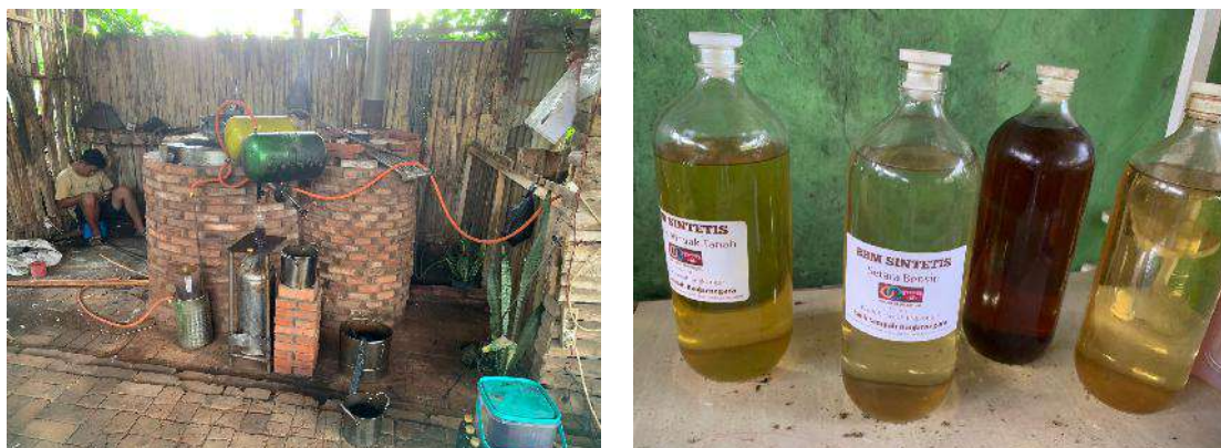
Gambar 4.4 Fast Pyrolysis untuk Penanganan Sampah Plastik menjadi Bahan Bakar Minyak dari Kabupaten Banjarnegara
