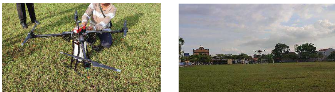
Gambar 4.6 Drone Pertanian Tipe Penyemprot
