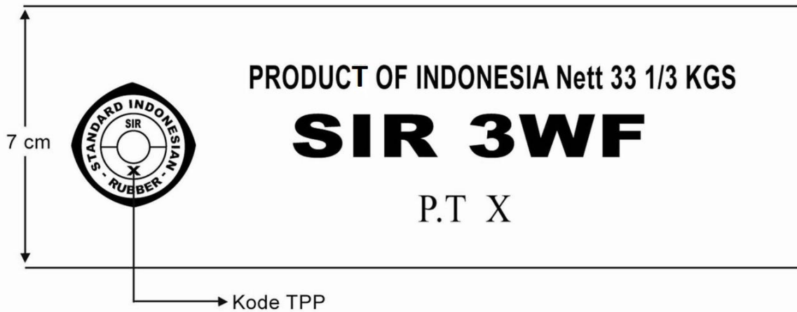
Gambar 8 - Contoh pencantuman penandaan pada pita polietilena
