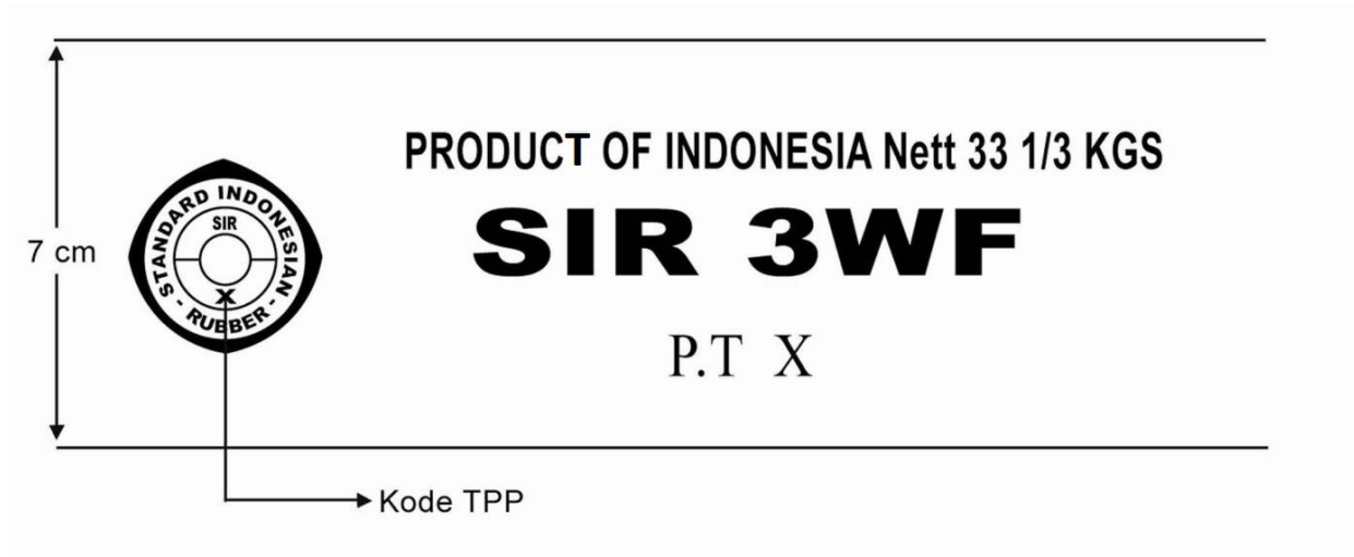
Gambar 4 - Contoh pencantuman penandaan pada pita polietilena
