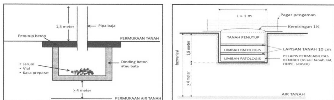
Gambar 3: Konstruksi Penguburan Limbah B3 COVID-1
