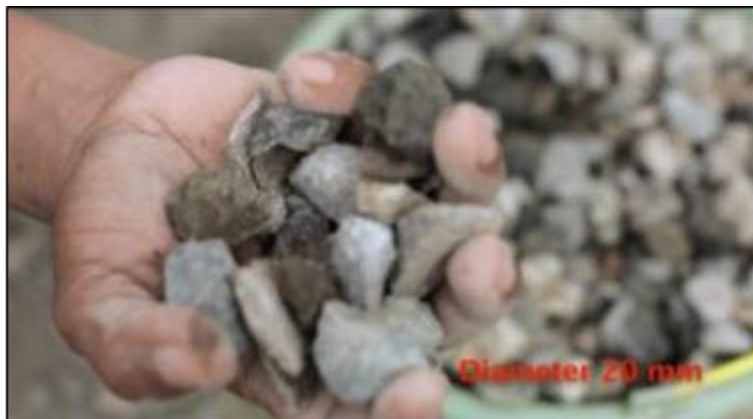
Gambar 5. Diameter Kerikil Yang Baik Untuk Campuran Beton
