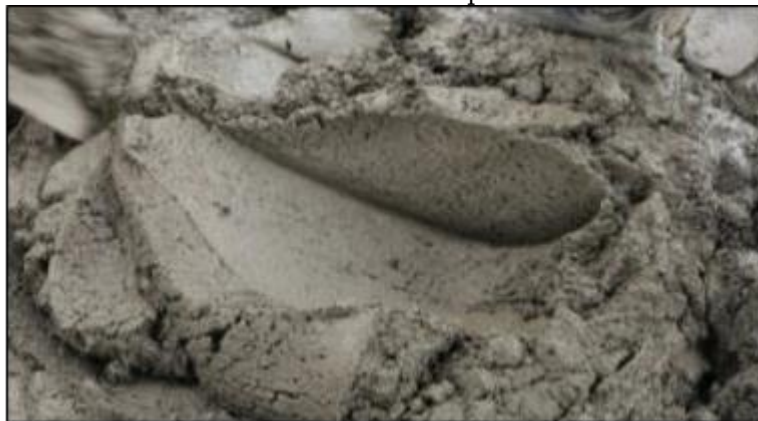
Gambar 9. Hasil Pencampuran Mortar Yang Baik
