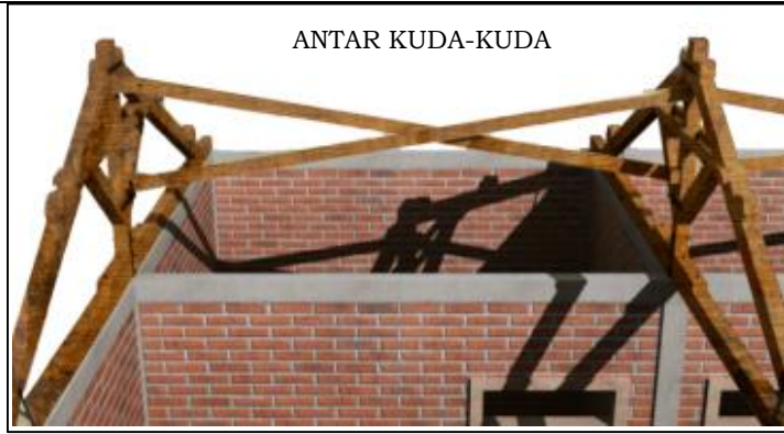
Gambar 34. Ikatan Angin Sebagai Pengikat Antar Kuda-Kuda Kayu
