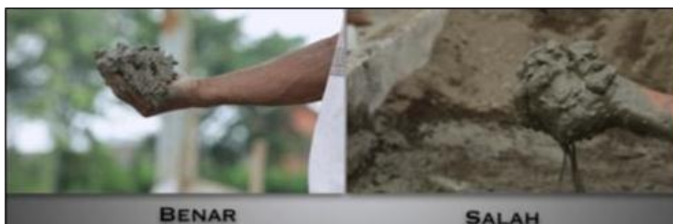
Gambar 3. Pengujian Sederhana Dengan Meletakkan Campuran Beton di Tangan
