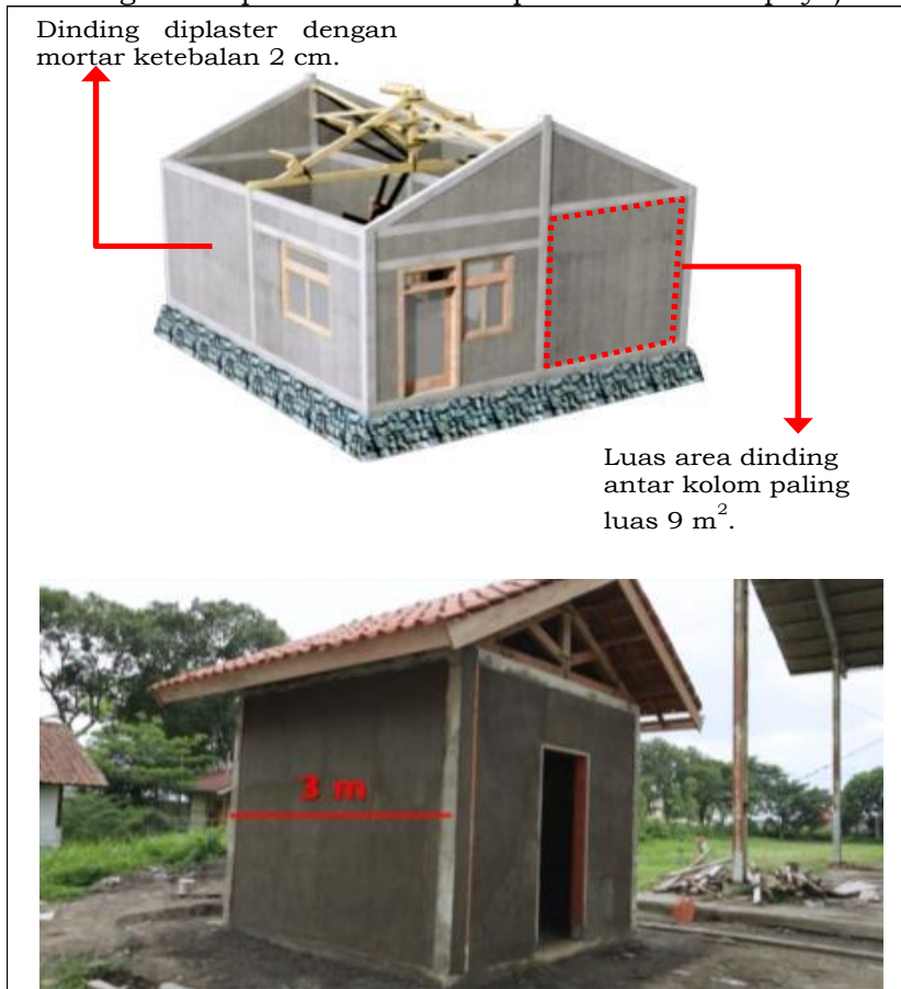
Gambar 42. Luas Maksimum Dinding dan Jarak Maksimum Antar Kolom
