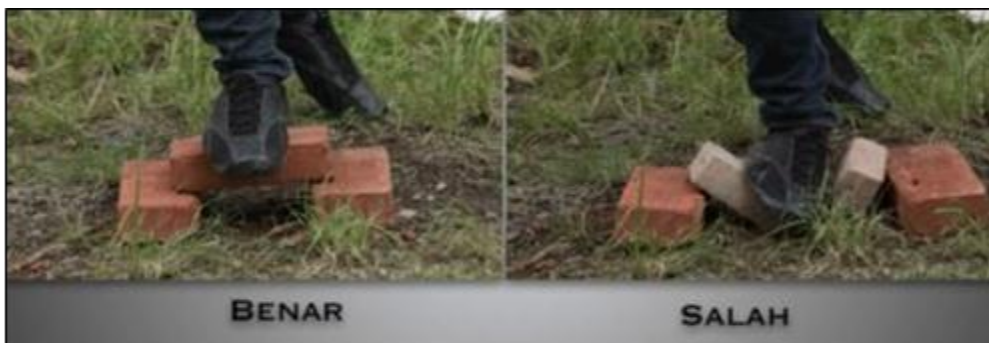
Gambar 13. Pengujian Sederhana Kekuatan Batu Bata
