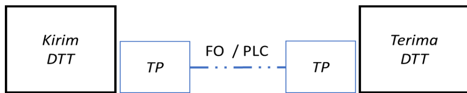
Gambar 8. Skema DTT 150 kV dan 66 kV
