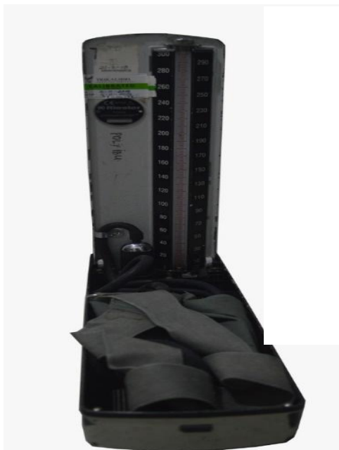
Gambar 3. Kemasan asli sebagai kemasan primer tensimeter/sfigmomanometer mengandung Merkuri
