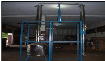
Gambar 17. Alat destilasi-dehidrasi etanol sistem Sinambung
