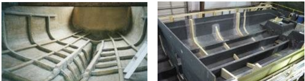
Gambar 11. Konstruksi Lambung Speedboat PSDKP
