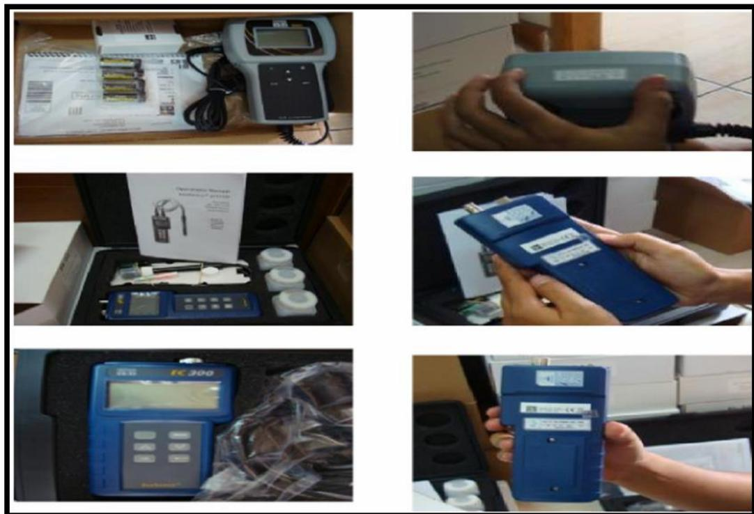
Gambar 1. Contoh alat bantu penyuluhan KP (DO Meter, pH Meter dan Salinity Meter)
