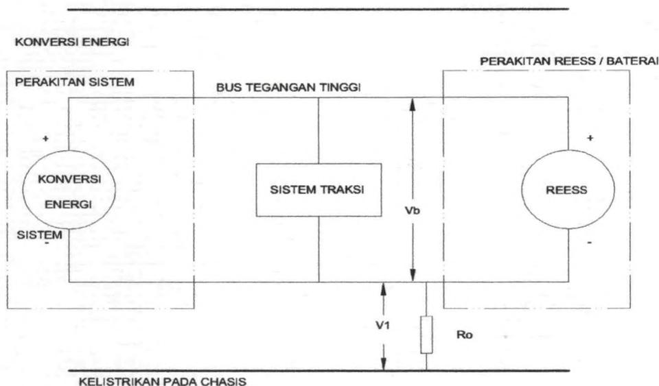
Jika  $V_2$  lebih besar dari  $V_1$ , masukkan resistensi yang dikenal standar ( $R_o$ ) antara sisi positif bus tegangan tinggi dan chassis listrik. Dengan  $R_o$  terpasang, ukur tegangan ( $V_2'$ ) antara sisi positif bus tegangan tinggi dan chassis listrik (lihat Gambar 3). Hitung isolasi listrik ( $R_i$ ) sesuai dengan rumus yang ditunjukkan. Bagi nilai isolasi listrik ini (dalam  $\Omega$ ) dengan tegangan operasi nominal bus tegangan tinggi (dalam Volts).
