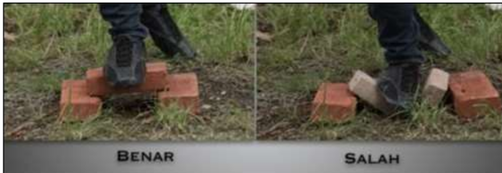
Gambar 13. Pengujian Sederhana Kekuatan Batu Bata
