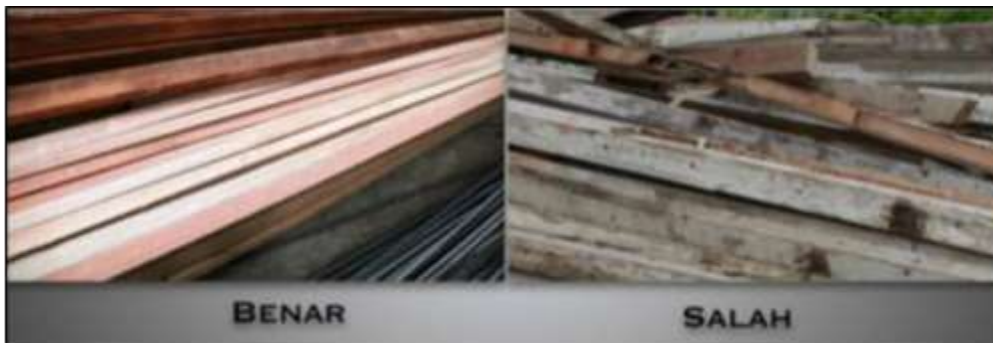
Gambar 16. Kayu Yang Baik Digunakan Dalam Pembangunan
