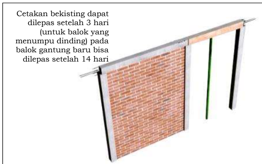
Gambar 61. Pelepasan Cetakan/ Bekisting
