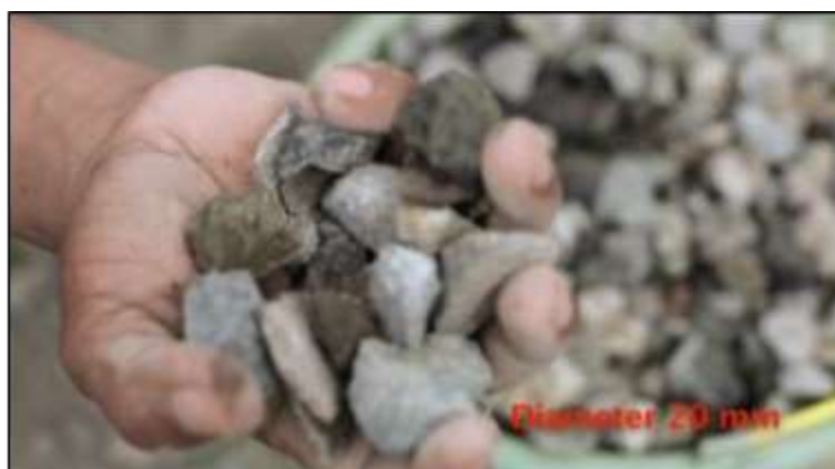
Gambar 5. Diameter Kerikil Yang Baik Untuk Campuran Beton
