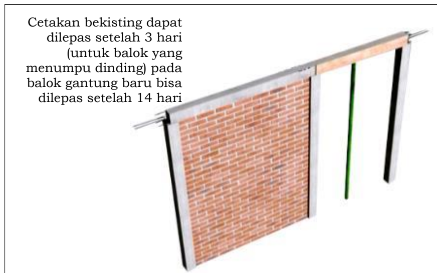
Gambar 61. Pelepasan Cetakan/ Bekisting
