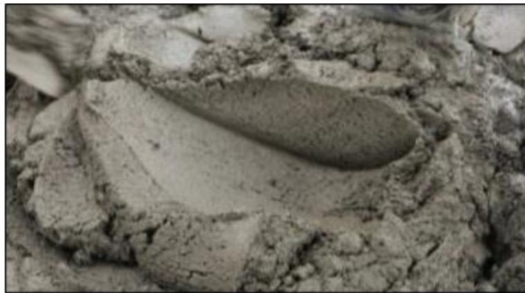
Gambar 9. Hasil Pencampuran Mortar Yang Baik
