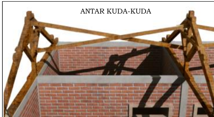
Gambar 34. Ikatan Angin Sebagai Pengikat Antar Kuda-Kuda Kayu
