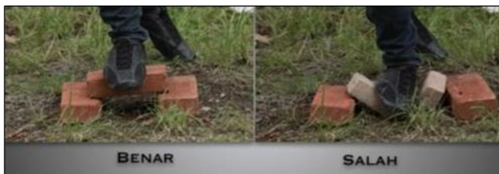
Gambar 13. Pengujian Sederhana Kekuatan Batu Bata
