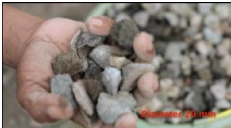
Gambar 5. Diameter Kerikil Yang Baik Untuk Campuran Beton
