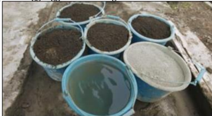
Gambar 7. Bahan Campuran Mortar
