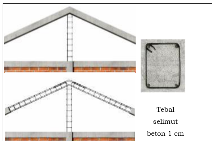
Gambar 33. Tulangan Pada Bingkai Gunung-Gunung/ Ampig
